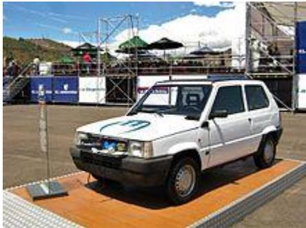
La **Panda Elettra** venne prodotta dal 1990 al 1998. Si trattava di una "conversione" a motore elettrico alimentato con batterie al piombo; probabilmente il prezzo di 25.600.000 lire, la scarsa autonomia (100 km a piena carica con batterie nuove), i lunghi tempi di ricarica (8-10 ore per una carica completa) ed altre limitazioni ne scoraggiarono l'acquisto e la diffusione, nonostante la buona ricezione da parte di pubblico e critica.
