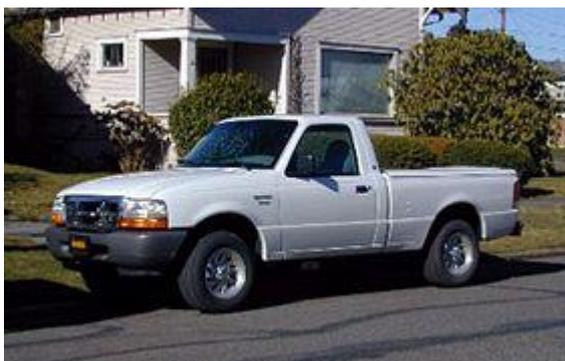
Il **Ford Ranger EV** (Electric Vehicle) è un pickup compatto alimentato a batterie ed è stato il primo veicolo Ford all-electric.
