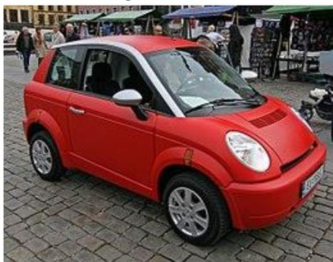
La vettura era realizzata con un telaio in lega d'alluminio rivestito da pannelli termoplastici, progettato per superare i crash-test. Queste
