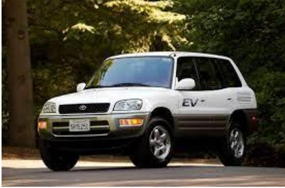
Aveva un'autonomia di (130–180 km) ed arrivava ad una velocità max. superiore ai 130 km/h, grazie a 24 batterie a 12V accumulatore NiMH.
